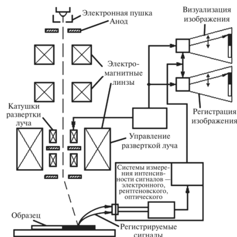
Рисунок 9 – Принципиальная схема работы СЭМ [40]
