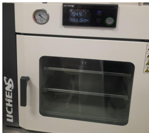
Рисунок 8 - Изготовленные массивы нанотрубок \text{TiO}_2 отжигались при 150^\circ\text{C} в течение 2 ч
