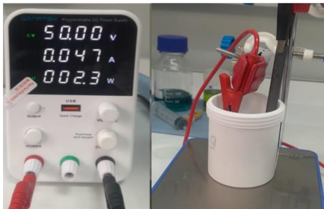
Рисунок 6 – Электрохимическое анодирование проводилось в двухэлектродной электрохимической ячейке, где титановая фольга служила анодом, а углеродный стержень – катодом ( U=60 В, I=0,03 А, t=2 ч.)
