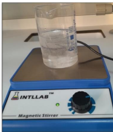
Рисунок 5 – Получение раствора электролита при помощи магнитной мешалки (содержание: этиленгликоль, содержащем 0,5 мас.% \text{NH}_4\text{F} и 2 об.% дистиллированной воды)
