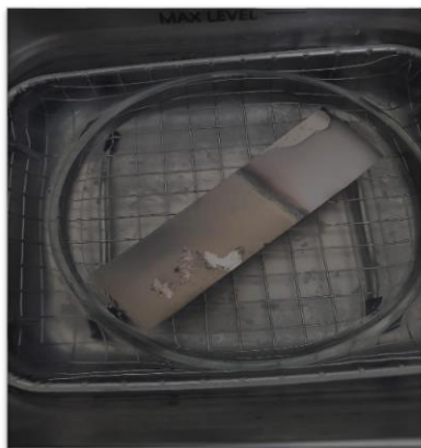
Рисунок 7 - Свежеприготовленные пленки нанотрубок были удалены путем ультразвуковой обработки в деионизированной воде ( t = 30 мин.)
